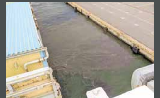
UKC が小さい船は大変。中々動きません。船底の水流が強く、水深11mの底から泥が噴出。
