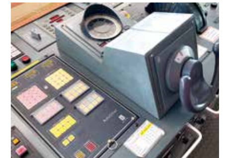
▲ BRIDGEコンソールにあるオーバーライドスイッチ群の一例
