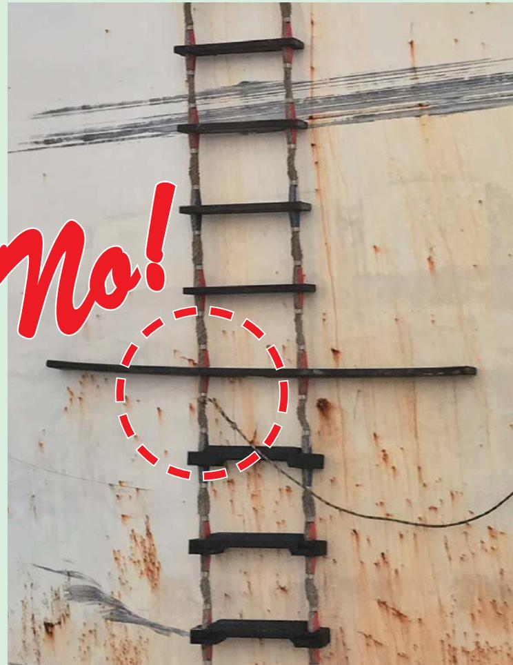
揚収索を取り付ける場合には、最下段のスプレッダーステップ又はその上方のスプレッダーステップの船首側に固縛する必要があります。
